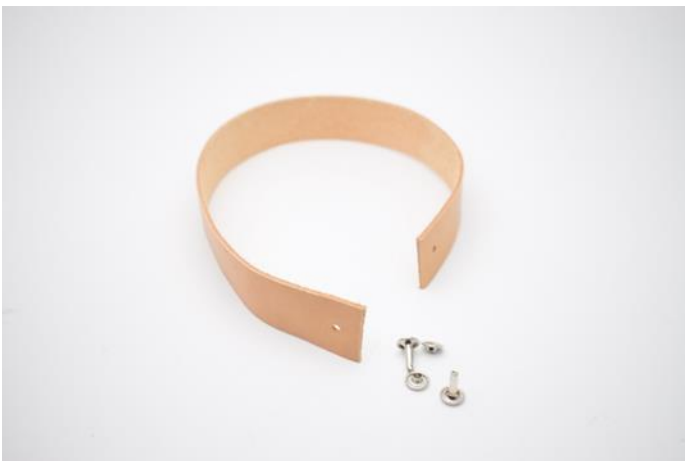
15. Schneide Deinen Lederriemen auf die passende Länge und runde evtl. die Enden ab. Mache Löcher für die Nieten mit einer Lochzange.
